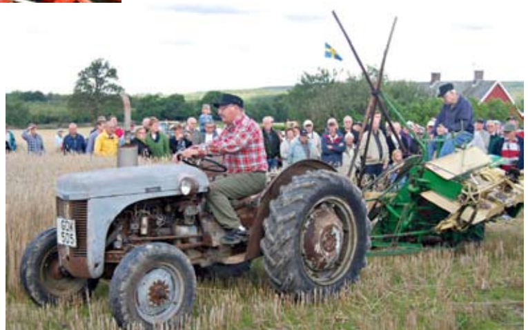
Stavhaspelbindare, lämplig för liggsäd, en ovanlig bindare från 40-talet, en sen konstruktion, traktordriven, redan då omdern för skördetröskor fanns redan. Kurt Löwgren med Börje Larsson på bindaren
