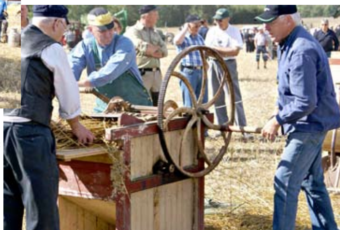
Handdriven stiftverkströska, gjorde tröskningen mycket snabbare än att stå på logen och plejla. Mannar från Onsjo häraads hembygdsförening.
