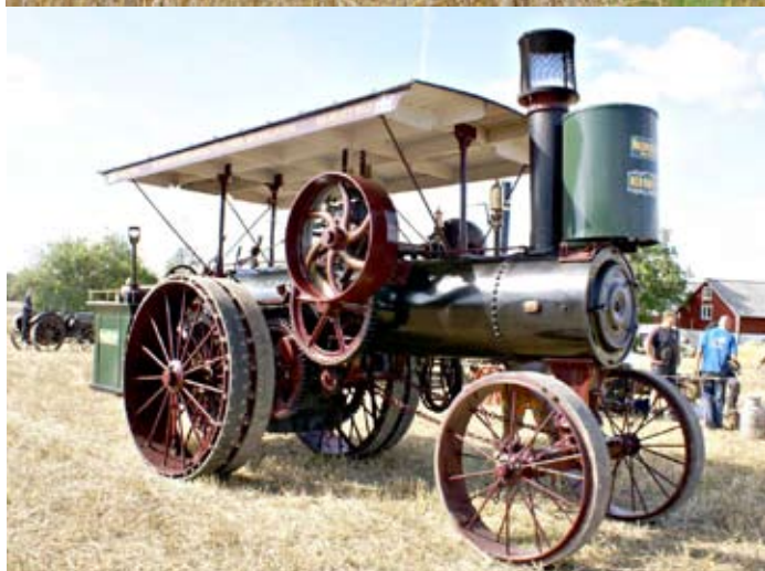
Ånglokomobil: drog töskverken mellan gårdarna och drev tröskorna. Från Kulabygdens lantbruksmuseum.
