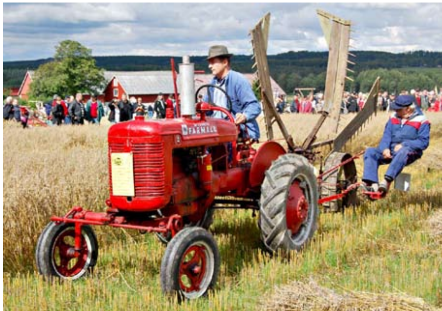
Avläggare: lägger säden i lagom buntar som sen får knytas för hand till fina kärvar, föregångaren till självbindare som själv knöt kärvarna. Gösta Johansson på avläggaren med sonen på traktorn
