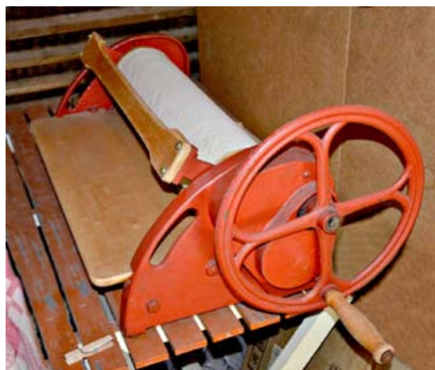
Stig Petterssons mangel är en ganska modern mangel med en mekanism som förenklar inläggningen av det som skall manglas.
