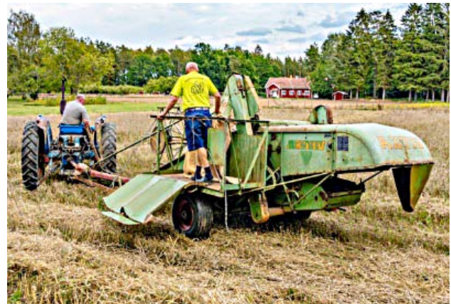
Senare modell av skördetröska, då fyllde man säden direkt i vagn.
