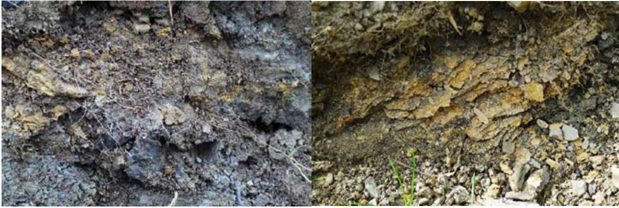
Den gulbruna bentonitleran kan ses på flera ställen vid kanten av det dike som löper parallellt med Kyrkbäcken
